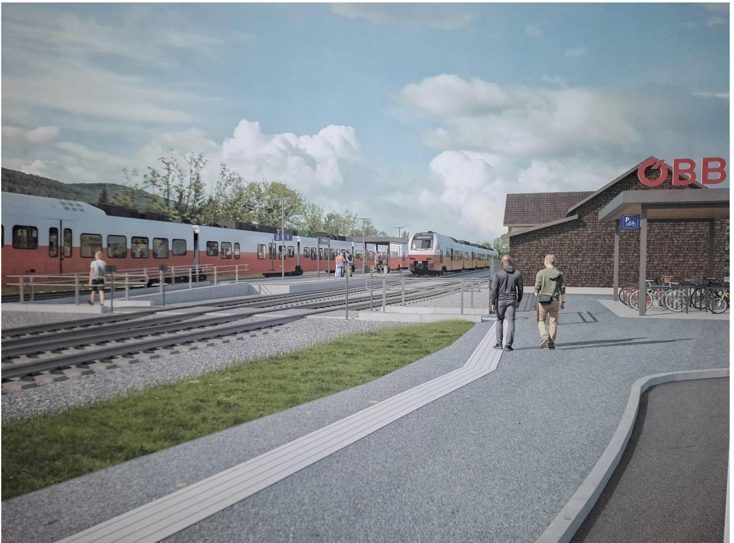
Planstudie vom Umbau des Bahnhofs in Willendorf. Es wird ein zusätzliches Gleis verlegt. Der Bahnsteig wird komplett erneuert und bekommt einen überdachten Wartebereich. Am Bahnhofsvorplatz ist eine befestigte Park&Ride Anlage geplant und es wird eine Wendemöglichkeit für Linienbusse geben. Ziel ist es, mit dem Busverkehr eine Anbindung an den Bahnhof zu schaffen, um dort das Umsteigen von Bus auf Bahn zu ermöglichen. Das bestehende Bahnhofsgebäude wird derzeit nicht entfernt
